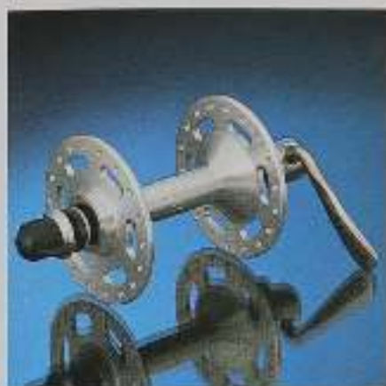
Orbit VS Ausführung : Mit Schnellspannung Typ : V 0101 Flanschhöhe : Hochflansch Gewicht : 260 g Achs-Gewinde : M 9 x 1
