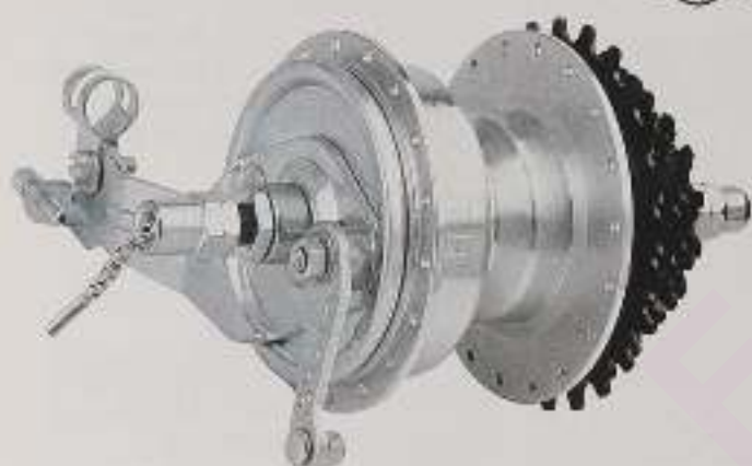
SACHS-Orbit HT. Hinterrad-Trommelbremsnabe mit 2 Gängen.
