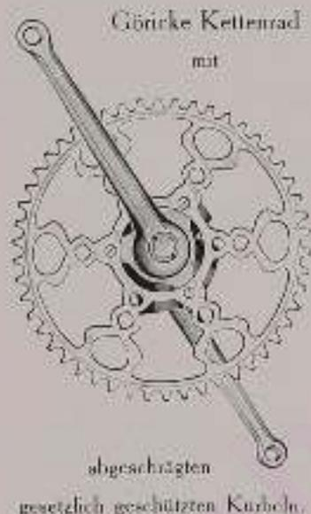
Die Tretlager meiner Modelle sind durch die Glocke der Kurbel überbaut und durch diese mustergültige Konstruktion der Kettenlauf innerhalb der beiden Kugellagen gebracht, wodurch der einseitige Druck auf das Lager vermieden wird. Durch diese sinnreiche Konstruktion wird der leichte Lauf der Göricke Räder erzielt.
