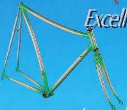
Tubes cintrés de haute technicité issus de l'aéronautique, entraxe arrière de 380 mm, plot dérailleur avant sur demande, fabrication pour roue avant de 600, 650 ou 700.
