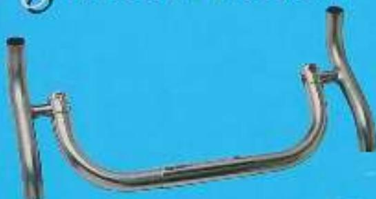
Souci d'ergonomie, de confort et d'efficacité : le guidon modulaire de MECACYCLE. Fabrication entièrement Dural, poids 380 g, pour portance à 26 mm. Largeurs Axe/Axe : 400, 420, 440.
