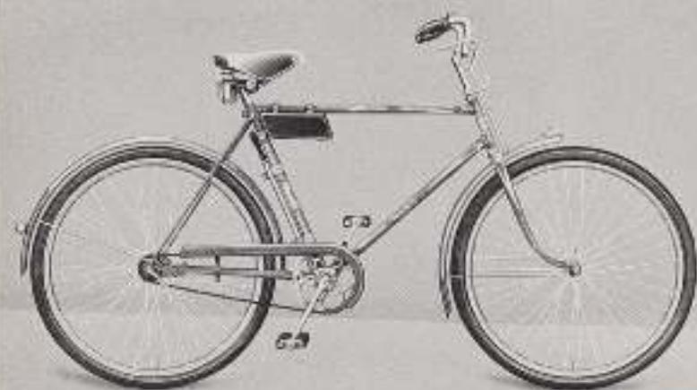
**Rahmen:** RIXE-Außenlösung, 52, 57 und 60 cm hoch, mit ausgeklippten Nulken, starrem Hinterbau und eingelöteten Ausfallenden.
