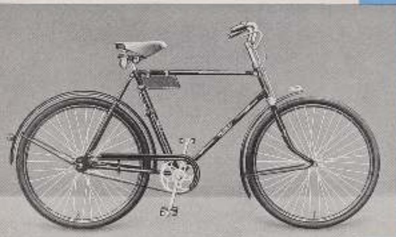
Rahmen: RIXE-Außenlötlung, 52, 57 und 60 cm hoch; bestes, deutsches Stahlrohr
