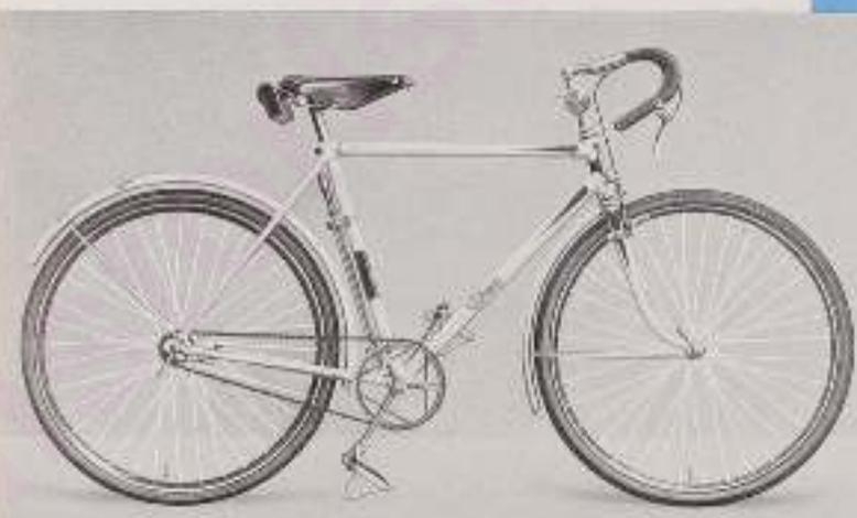
**Rahmen:** RIXE-Außenlösung, 52, 56 und 60 cm hoch, garantiert nahtlos gezogene Stahlrohre mit ausgeklippten Zier-Nulken, profilierten Hinterrad-Strahen und eingelöteten Ausfallenden.
